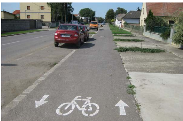
5. kép: Kétirányú kerékpárút közvetlenül a hosszában parkoló autók mellett, hirtelen kinyíló autójáték elleni védelemre szolgáló védősáv nélkül (Burgenland)
