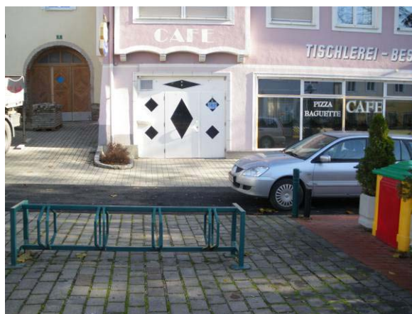
18. kép: Kerékpártároló megvilágítás, időjárás elleni védelem és a váz lezárási lehetősége nélkül (Burgenland)
