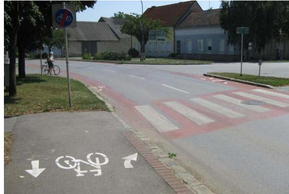
Abbildung 12: Rot hervorgehobener Schutzweg an einer Querungsstelle im Verlauf einer Radroute mit missverständlichen Piktogrammen für Radfahrer (Burgenland)
