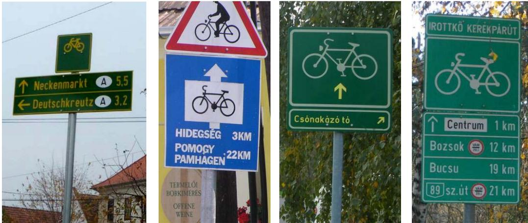
Abbildung 24: uneinheitliche Gestaltung ungarischer Radwegweisung: unterschiedliche Schildergröße und Form, Zielangaben teilweise ohne Richtungspfeil und Kilometerangaben,
