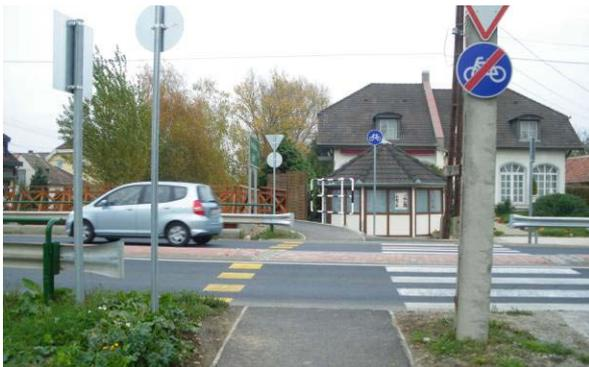
Abbildung 9: Radfahrerüberfahrt neben einem Schutzweg mit benachrangtem Radverkehr mittels VZ „Vorrang geben“ und VZ „Ende des Radweges“ (Ungarn)
