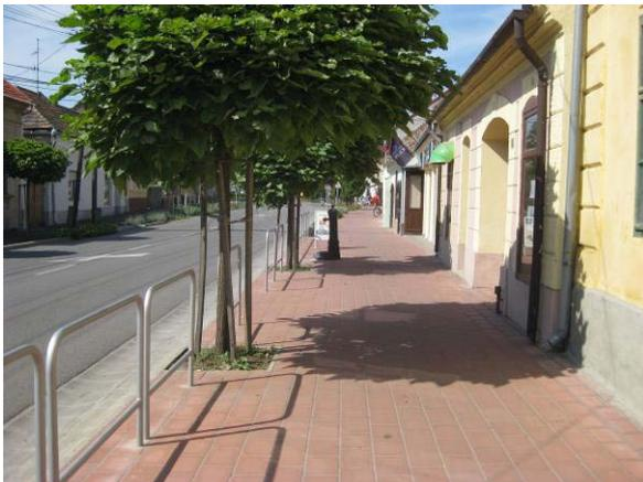
Abbildung 8: Radfahranlage mit Absperrungen in Form von Geländern (Ungarn)
