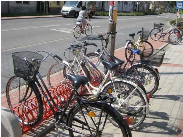
Abbildung 17: Abstellanlage ohne Witterungsschutz und ohne Absperrmöglichkeit des Rahmens (Ungarn)
