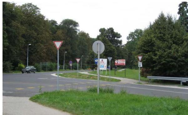
Abbildung 10: Radfahrerüberfahrt mit unklarer Vorrangsituation, sowohl Kfz- als auch Radverkehr werden mittels VZ „Vorrang geben“ benachrangt (Ungarn)
