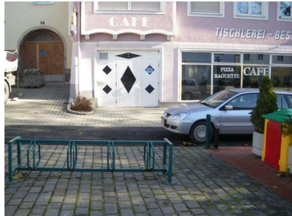
Abbildung 18: Abstellanlage ohne Beleuchtung, Witterungsschutz und Absperrmöglichkeit des Rahmens (Burgenland)
