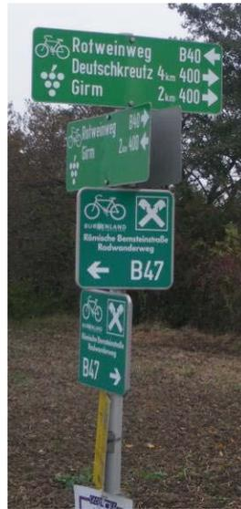
Abbildung 22: uneinheitliche Gestaltung von alten und neuen Radwegweisern
