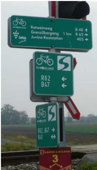
Abbildung 21: Burgenländische Wegweisung mit Verwendung unterschiedlicher Wegweiser-Typen auf einem Steher (Haupt- und Zwischenwegweiser) und uneinheitlichem Informationsgehalt
