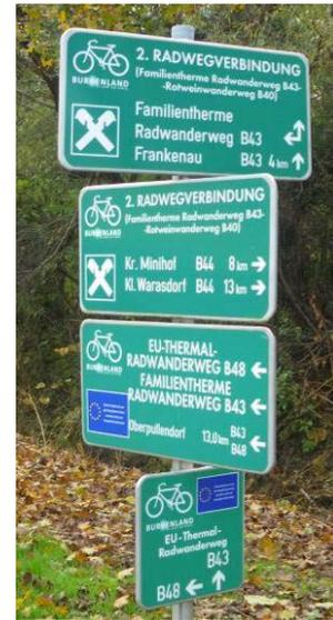
Abbildung 23: Stellenweise unübersichtliche Wegweisung auf Grund vieler Überschneidungen bestehender Radrouten und Verwendung unterschiedlicher Wegweiser-Typen auf einem Steher
